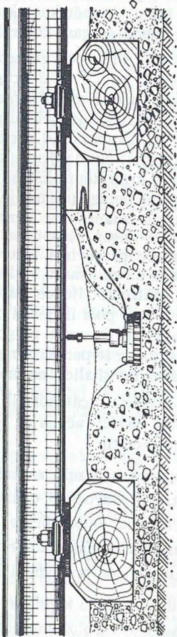
Sl. 72. Naoružavanje mine elektromehaničkim upaljačem kada se priprema za aktiviranje na nagaz
